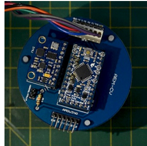
Muestra de un módulo de computadora de vuelo con un sensor de aceleraciones (izquierda) y una computadora tipo Arduino Pro Mini (centro)
