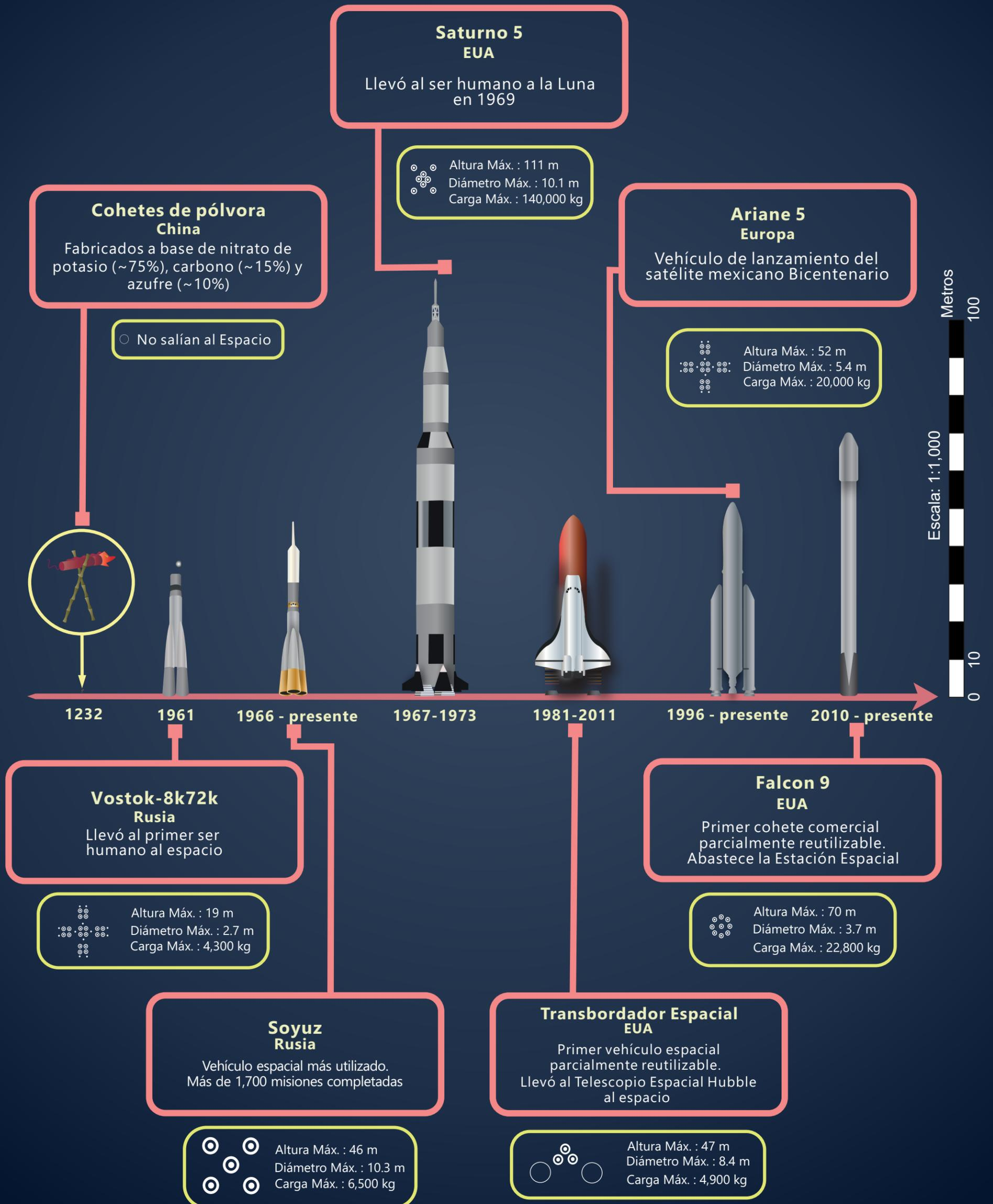
\*La carga máxima reportada es de órbita baja, (LEO, Low Earth Orbit), que se encuentra entre los 200 y 2,000 kilómetros de altura sobre el nivel del mar.
