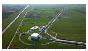
El detector VIRGO de ondas gravitacionales, ubicado en Italia. Al pasar ondas gravitacionales por la Tierra, los brazos, de 3km de largo, cambian su longitud y el laser que circula en el interior del túnel refleja estas variaciones permitiendo la detección de las ondas. Crédito de la imagen: Colaboración VIRGO.
