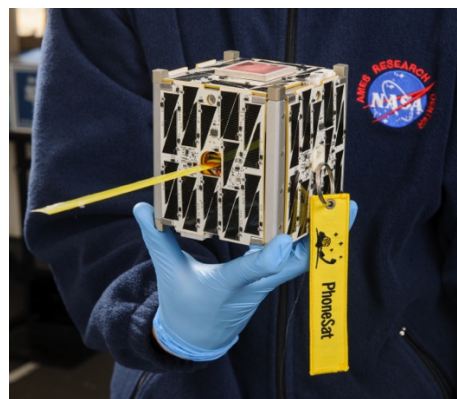
CubeSat de una unidad, 10x10x10 cm (Imagen: NASA)
